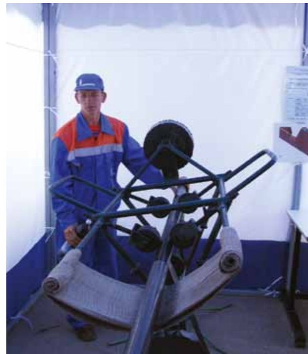
Установка по изоляции стальной трубы
